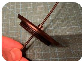
5. Ajuste el cable de alimentación a la longitud que desea, retire el recubrimiento de los cables rojo y negro.
