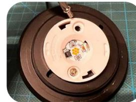
4. Retire los tornillos que sujetan la base del LED.
