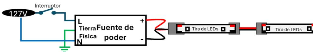
**El conector es IP20 (Para uso en interiores). Si requiere usarse con tiras de LED IP66 en exteriores, se debe cubrir la conexión con la tira usando termofit y silicón tipo DownCorning o similar**
