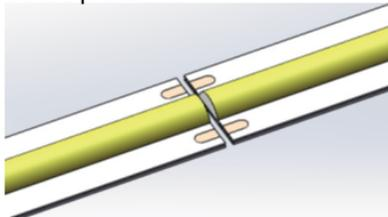
2. Inserte la tira de LED de manera que las laminas coincidan con las pistas de cobre.
