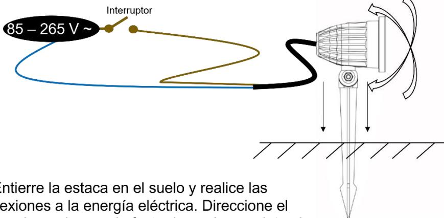
3. Entierre la estaca en el suelo y realice las conexiones a la energía eléctrica. Direcione el cabezal para lograr el efecto deseado y apriete el tornillo de ajuste. Encienda el luminario y pruebe su funcionamiento
