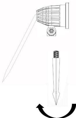
2. Ensamble la estaca al cabezal
