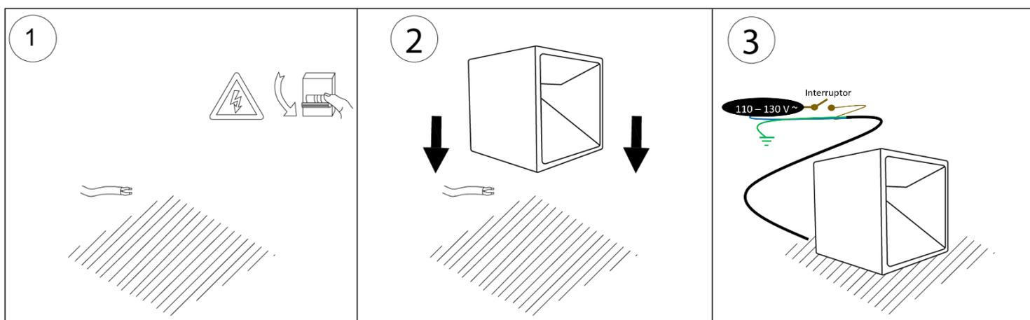
1. Apague la energía eléctrica y pase el cable de alimentación hasta el luminario.
