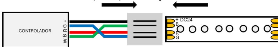
4. Conecte los cables a la fuente de poder y compruebe el funcionamiento.
