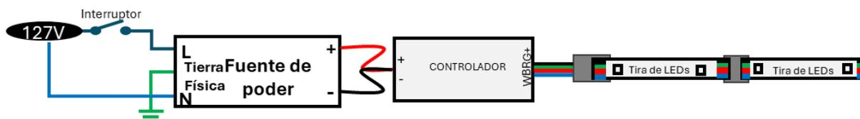
**El conector es IP20 (Para uso en interiores). Si requiere usarse con tiras de LED IP66 en exteriores, se debe cubrir la conexión con la tira usando termofit y silicón tipo DownCorning o similar**
