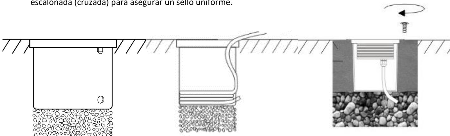
Sellar usando silicón transparente en el borde del cristal, inmediatamente después colocar la tapa de acero inoxidable y atornillar para que la tapa haga presión sobre el empaque.
