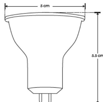
Lámpara tipo dicróico con base MR16 y ángulo de 38°, atenuable (Compatible con dimmers tipo TRIAC).
