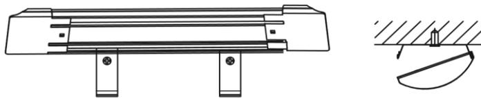
Inserte el otro extremo del luminario al otro extremo de las grapas como se muestra en el esquemático siguiente.
