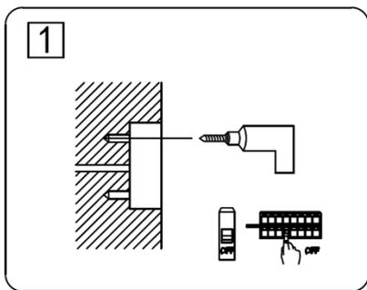
1. Verifique que la energía eléctrica esté apagada. Ubique los puntos de sujeción y coloque taquetes.
