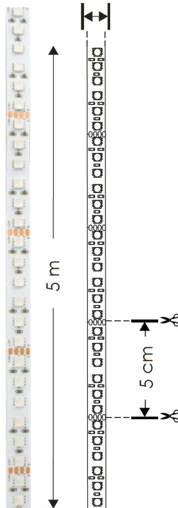
Tira extraplana para interiores, 120 LEDs por metro modelo 4040, rollo de 5m. Cinta 3M autoadherible para su fijación, cortes cada 5cm
