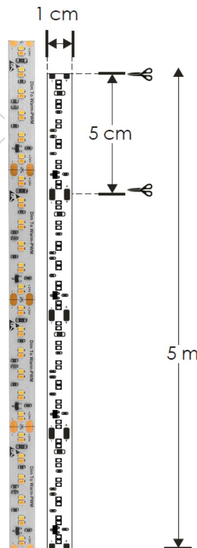
Tira de LED con cambio de color por medio de atenuación (PWM), compatible con fuente de poder de 5EN1. Con posibilidad de controlar con atenuadores (dimmers) tipo TRIAC, 0-10V, 1-10V, PWM o Potenciómetro. Fuente de poder no incluida, modelos recomendados: ILUDA5EN1100W24, ILUDA5EN1200W24 (Consulte manual de operación y especificaciones de la fuente de poder a utilizar).
