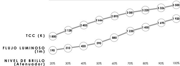
**NOTA:** Tira de LED con cambio de color por medio de atenuación (PWM), compatible con fuente de poder 5EN1. Con posibilidad de controlar con atenuadores (dimmers) tipo TRIAC, 0-10V, 1-10V, PWM o Potenciometro. Fuente de poder no incluida, modelos recomendados: ILUDA5EN1100W24, ILUDA5EN1200W24, ILUDA5EN1350W24 (Consulte manual de operación y especificaciones de la fuente de poder a utilizar).
