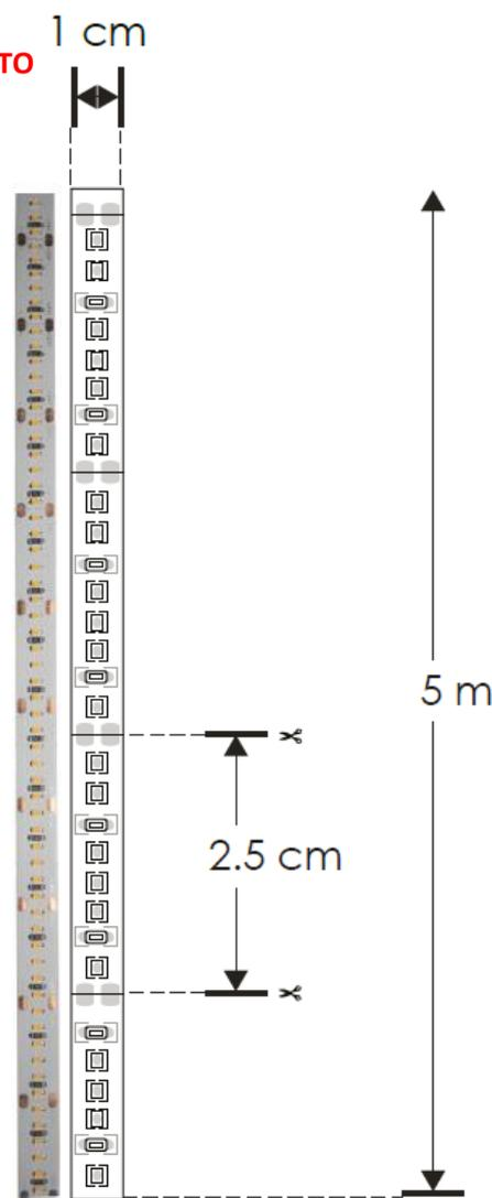
Tira extraplana para interiores de 240 LEDs por metro tipo 2216, rollo de 5m
