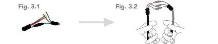
4.- Realice el aislamiento cubriendo la cinta vulcanizable desde el conductor de alimentación en dirección del cable de la luminaria.
