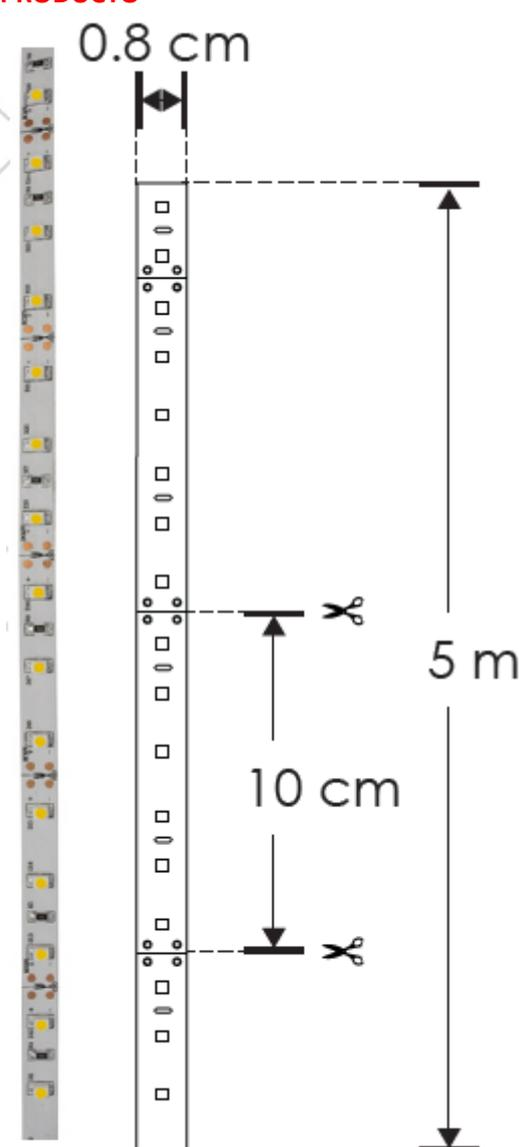
Al no tener cubierta de resina sino barniz con tecnología nano, prolonga la vida del LED (por calentamiento) y no hay amarillamiento. Ideal para exteriores pues se puede mojar o en lugares con alta humedad (No para uso subacuático o en contacto con el agua por tiempo prolongado).
