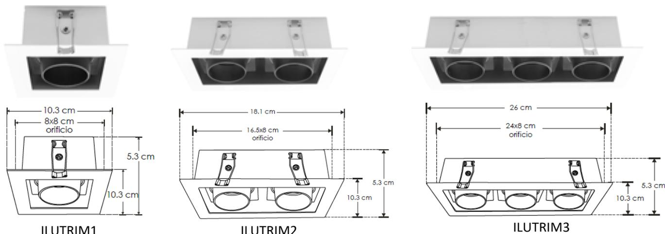
Este producto es usado como difusor de lámparas tipo MR16, GU10 o módulos de leds cuyo diámetro sea igual a 5 cm (no incluye lámpara). ILUTRIM 1 incluye una base MR16, el ILUTRIM2 incluye dos bases MR16 y el ILUTRIM3 incluye 3 bases MR16. Grado de protección IP20 (para uso en interiores). Características de la(s) base(s) incluida(s): 277 V ~ 50/60 Hz 0.28 A max 35W máx (Por cada base MR16).
