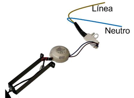
Realice las conexiones (Cables cafés línea, Cables azules neutro).
