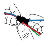
Fig. 1.3 Coloque cinta masilla en el tercer conductor, incorporando este último con los dos anteriores en ambos cables de alimentación eléctrica y cable de la luminaria.
