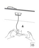
Ubique el controlador (driver) del luminario por arriba del plafón y fije el luminario con los soportes laterales.
