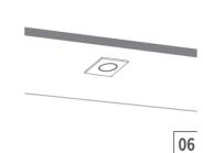
Coloque el luminario en el orificio Encienda la energía eléctrica. del techo.
