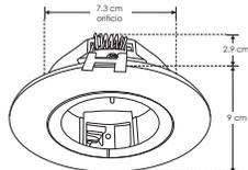
**NOTA:** No es necesario desmontar el difusor para realizar el cambio de la lámpara, se hace por la parte inferior.
