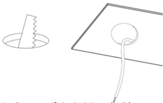
2. Realice un orificio de 3.2cm de diámetro en la superficie donde va a instalar el luminario y pase los cables de alimentación por el orificio
