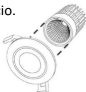
Diagrama típico de cómo se ensambla el módulo con los accesorios.
