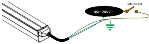
1. Verifique que la energía eléctrica esté apagada, conecte el luminario con el conector CONINTG30CM o CONINTG150CM (No incluidos). Encienda la energía eléctrica y pruebe el funcionamiento
