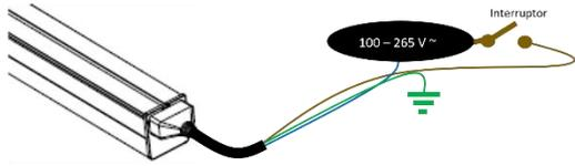
1. Verifique que la energía eléctrica esté apagada, conecte el luminario con el conector CONINTG30CM o CONINTG150CM (No incluidos). Encienda la energía eléctrica y pruebe el funcionamiento
