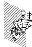
4. Coloque la lámpara E27 (no incluida) en la base del luminario.
