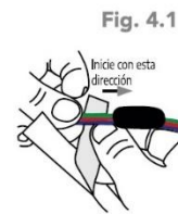
Fig. 1.4 Con los pasos anteriores se generó un sello que evitará el paso de humedad.
