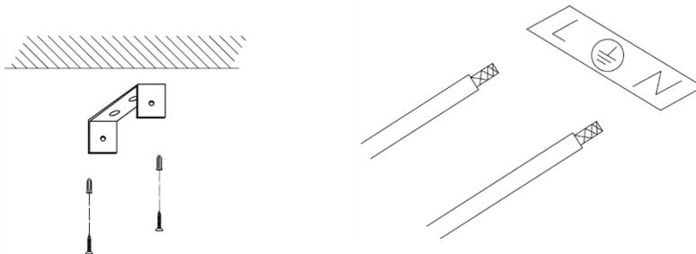
2. Ubique el área donde va a instalar el luminario y haga un orificio para el cable de alimentación. Fije la base de sujeción.
