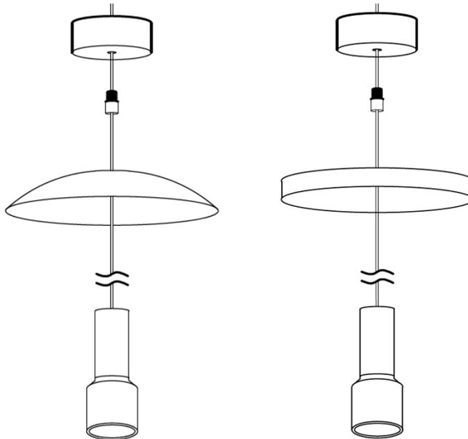
Pase el cable de sujeción por el orificio central de la pantalla.
