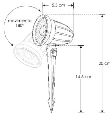
Este producto es usado como elemento de iluminación en piso para, jardines, muros, columnas y áreas exteriores. Incluye estaca.
