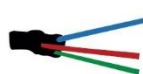
Fig. 1.4 Con los pasos anteriores se generó un sello que evitará el paso de humedad.
