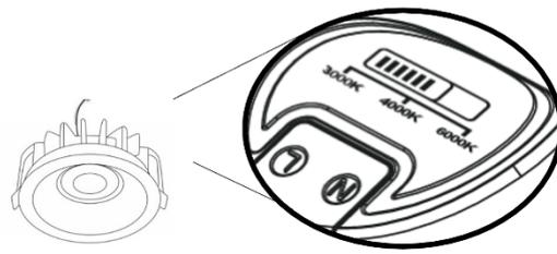
2. Coloque el selector en el tono de luz deseado.
