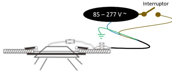
5. Inserte el luminario en el orificio asegurándolo con los soportes laterales.
