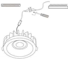
4. Haga las conexiones a la línea eléctrica en los bornes de alimentación.
