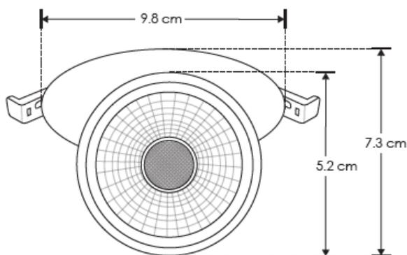
Este producto es usado como elemento de iluminación general en plafones y techos. Compatible con bote integral del número 8 y con lámparas GU10 de hasta 35W. Lámpara no incluida. Incluye base GU10.
