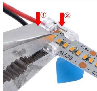
Presione ligeramente los contactos metálicos del conector usando unas pinzas de punta.
