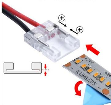
Retire la protección del adhesivo de la tira de LED e inserte la tira en la ranura del conector.
