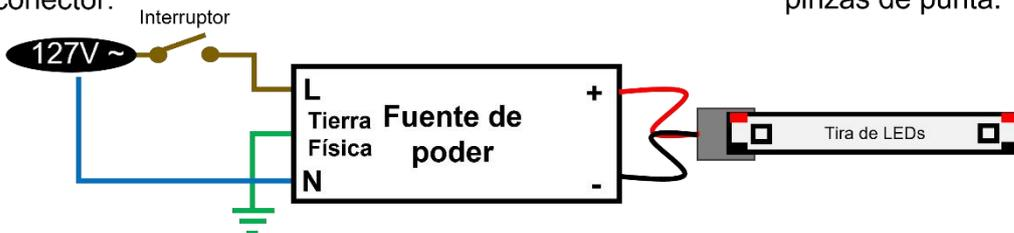
**El conector es IP20 (Para uso en interiores). Si requiere usarse con tiras de LED IP66 en exteriores, se debe cubrir la conexión con la tira usando termofit y silicón tipo DownCorning o similar**
