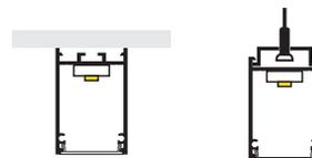
**Material** Kit de perfil de aluminio sin ceja, acabado negro rectangular de sobreponer o suspender, 2 m de largo, para recibir tira extraplana de LEDs o tarjeta de LEDs
