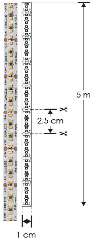
Tira extraplana para interiores y exteriores de 240 LEDs por metro tipo 2216, rollo de 5m. Con cinta 3M autoadherible para su fijación, cortes cada 2.5cm
