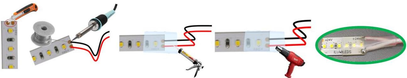
Para el aislamiento de los cables, use el siguiente método:
