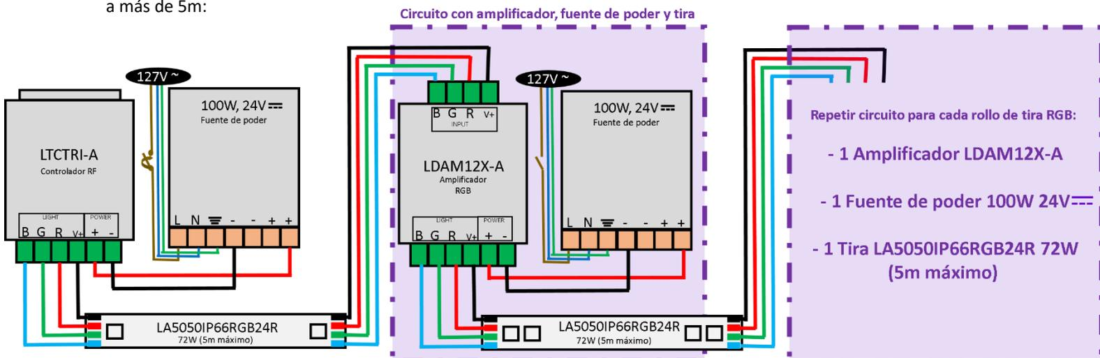
**NO CONECTE LA TIRA DE LEDS DIRECTAMENTE A LA CORRIENTE ELÉCTRICA (SIN FUENTE DE PODER) PORQUE EL PRODUCTO SUFRIRÁ DAÑOS IRREPARABLES Y PÉRDIDA DE LA GARANTÍA, SIEMPRE DEBE EMPLEARSE UNA FUENTE DE ALIMENTACIÓN PARA SU CORRECTO FUNCIONAMIENTO.**
