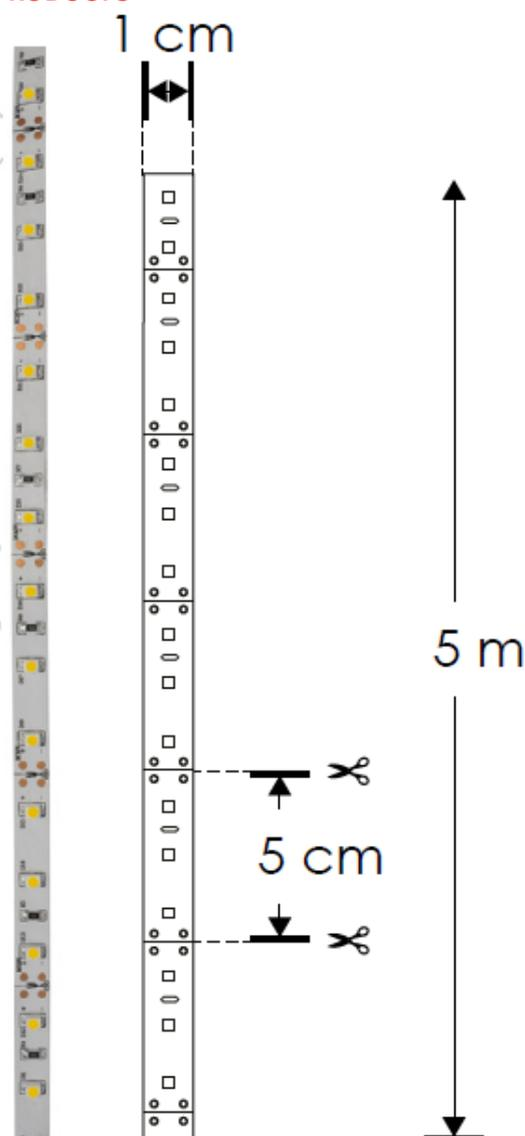
Al no tener cubierta de resina sino barniz con tecnología nano, prolonga la vida del LED (por calentamiento) y no hay amarillamiento. Ideal para exteriores pues se puede mojar o en lugares con alta humedad (No para uso subacuático o en contacto con el agua por tiempo prolongado).
