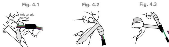
5.- Recubre todo aislamiento con la cinta vinil del cable de alimentación en dirección al cable de la luminaria.
