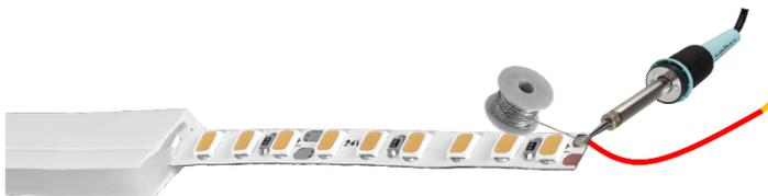
Para soldar cables a la tira de LED, retire el recubrimiento de silicón para que la tira interna quede visible. Realice la soldadura en los pads de cobre respetando la polaridad.
