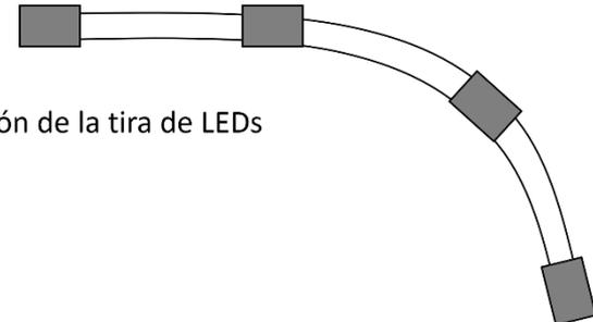
Utilice las grapas de fijación necesarias dependiendo de la posición de instalación de la tira de LEDs
