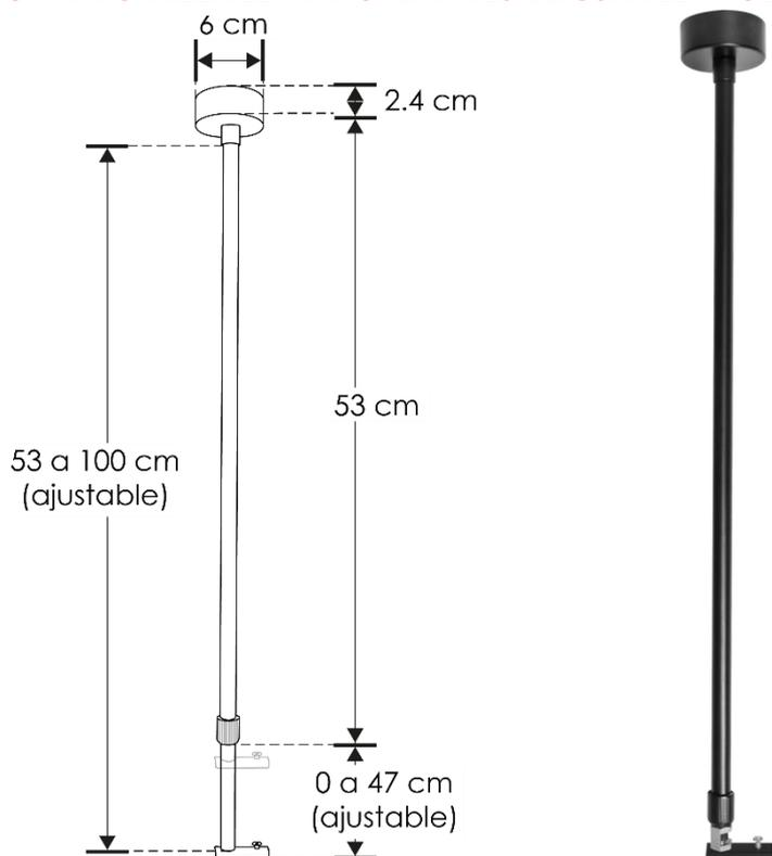
Kit de suspensión para riel magnético, Incluye, 1 barra ajustable de 0.5 – 1m de largo, canope, base de sujeción, barra metálica, 5 tornillos, rondana de presión, base cilíndrica y kit de pijas y taquetes.
