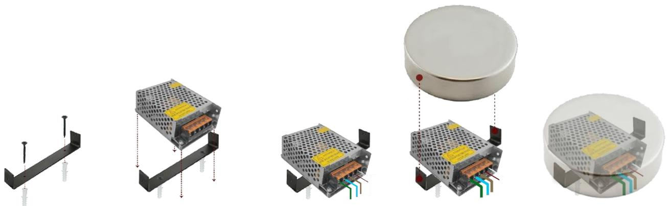
Nota: Es importante que la fuente de poder se ubique unida sobre el muro, los cables de alimentación de energía eléctrica deben situarse adyacentes a la fuente de poder como se muestra en el diagrama.
