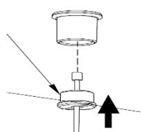
2. Inserte el cable de acero en la tapa de la base.
