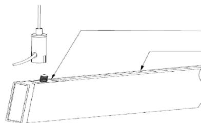
3. Inserte el cable de acero en el cilindro inferior y ajuste a la longitud deseada.
