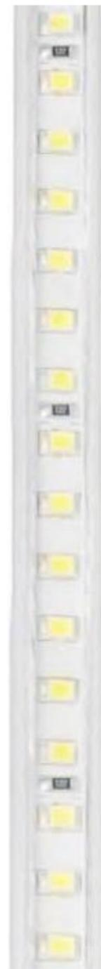
Kit de manguera de LEDs a 127 V ~ que incluye: Rollo de 5 m de manguera de LED 2835 120 LEDs por metro, 1 conector, 5 terminaciones de silicón, 11 grapas, 22 tornillos.
