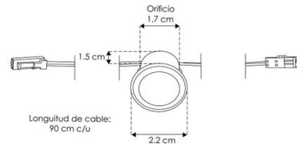
Utilizado como atenuador de intensidad de luz (dimmer) con función de apagado y encendido de tiras extraplanas del tipo monocromático para instalar en muebles (empotrado).
