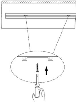
1. Fije la base de sujeción a la superficie donde se va a instalar el mini riel magnético
