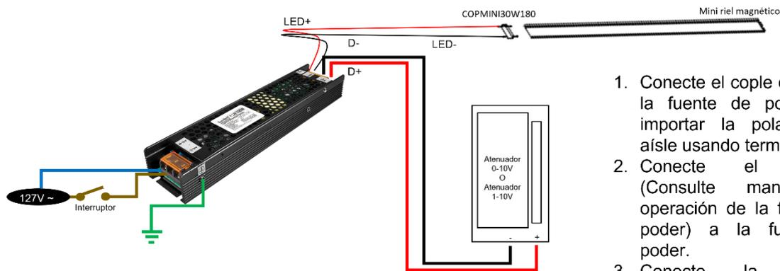
1. Conecte el cople de 180° a la fuente de poder (Sin importar la polaridad) y aisle usando termo fit.
