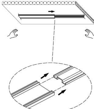
2. Inserte u deslice el mini riel magnético por la base de sujeción.
