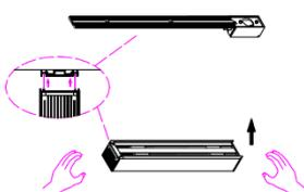
4. Asegúrese que los pines de salida de la fuente hagan contacto con el mini riel magnético. Encienda y pruebe su funcionamiento.
