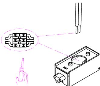
1. Destape la caja de conexiones de la fuente de poder e introduzca los cables de alimentación por el orificio. Realice las conexiones en los bornes correspondientes.
