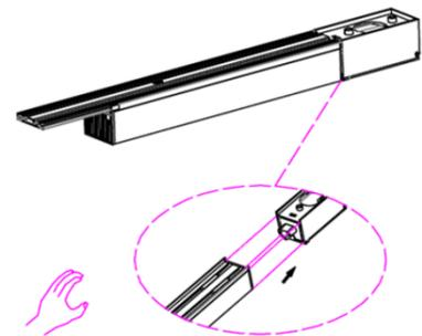
3. Coloque la fuente de poder insertando el conector en el puerto lateral.
