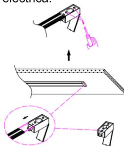
2. Ponga la caja de conexiones en el extremo del riel magnético y fijela usando pijas y taquetes. Cierre la caja de conexiones.
