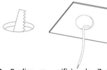
2. Realice un orificio de 7cm de diámetro en la superficie donde va a instalar el luminario.
