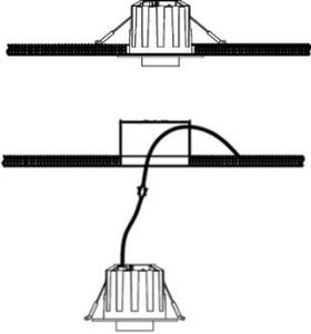
4. Haga las conexiones a la línea eléctrica y aisle. Coloque el luminario en el orificio y asegúrelo con los soportes laterales.
