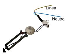
Realice las conexiones (Cables cafés línea, Cables azules neutro).
