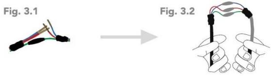
4.- Realice el aislamiento cubriendo la cinta vulcanizable desde el conductor de alimentación en dirección del cable de la luminaria.
