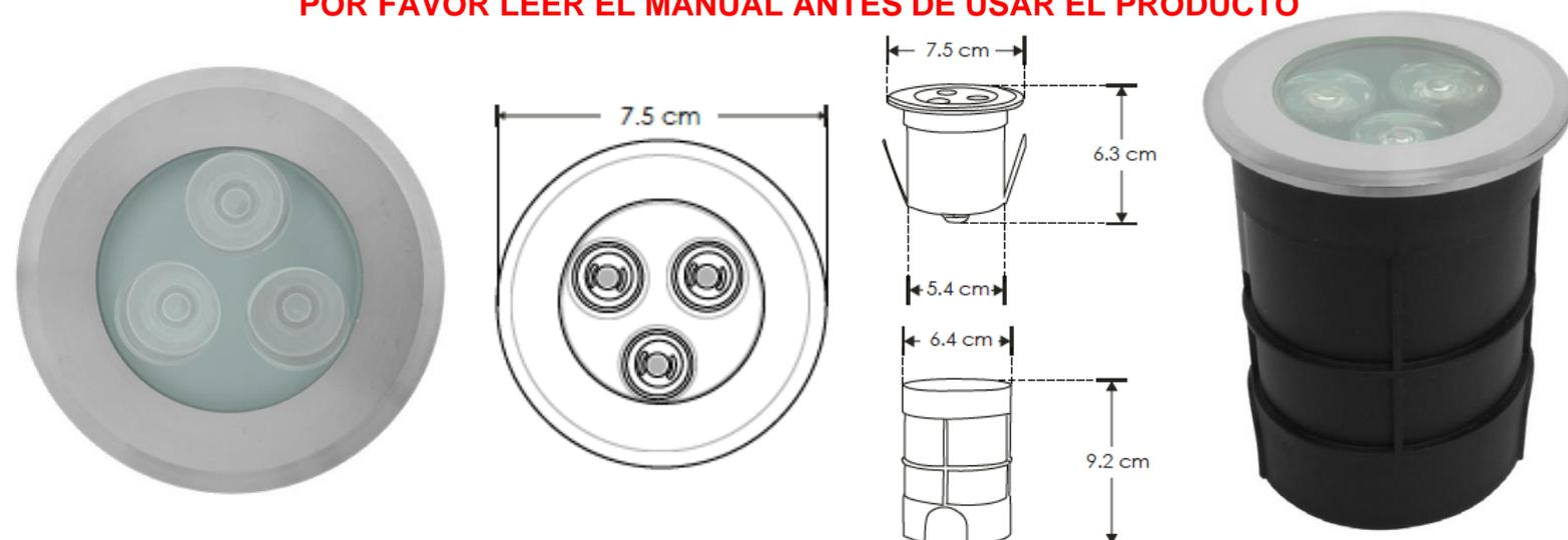
Luminario subacuático empotrable con 3 LEDs de 3 W cada uno RGB 3 en 1, utilizado como elemento de iluminación en albercas y fuentes. Requiere de un controlador y fuente de alimentación de 24 V  $\equiv$  (no incluido, modelos sugeridos YLC004, YLC004S).
