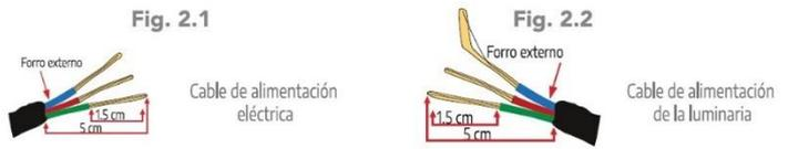
3.- Realice el empalme los conductores 1 a 1 utilizando ambas cintas (cinta masilla y cinta vulcanizable) como lo realizó en el paso 1.
