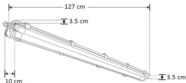
Luminario tipo gabinete a prueba de vapor. Este producto es usado como elemento de iluminación en estacionamientos, albercas techadas, refrigeradores industriales y donde se requiera un luminario a prueba de vapor.
