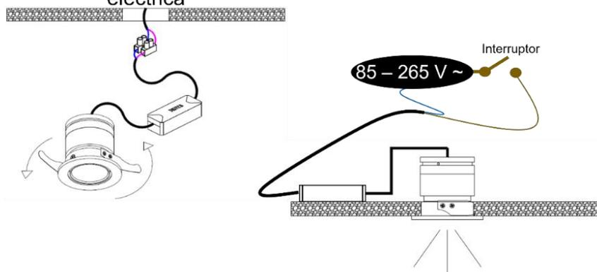
3. Inserte el luminario y asegúrelo con los soportes laterales, enciéndalo y pruebe su funcionamiento. Los modelos de 5 y 7W son dirigibles, por lo que puede ajustar el haz de luz para crear el efecto deseado.
